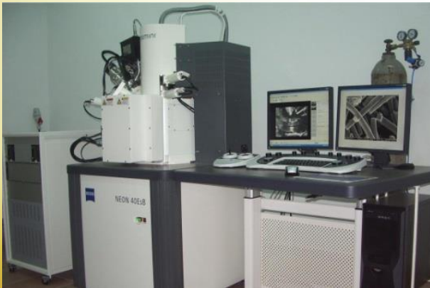
Carl Zeiss NEON40 EsB CrossBeam (UHR-SEM, FIB, GIS, EBSD, detector InLens și EBS, EDS)
